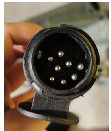
Der Stecker des Anhängers für die Autoelektronik
